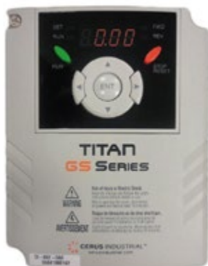
Imagem 4 – display do inversor na posição “0.00”
